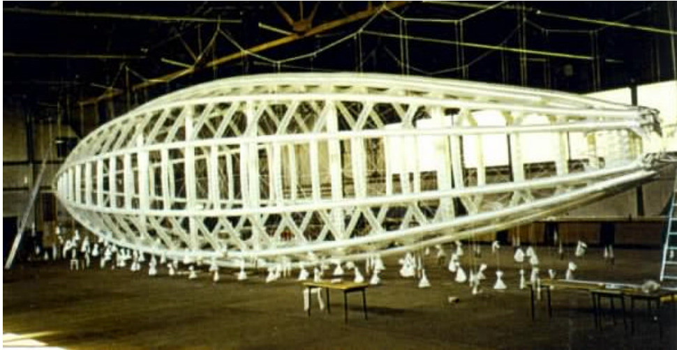
Abb. 4.56: Tragestruktur mit luftgefüllten Schläuchen des Luftfahrtpioniers J. Bracher
